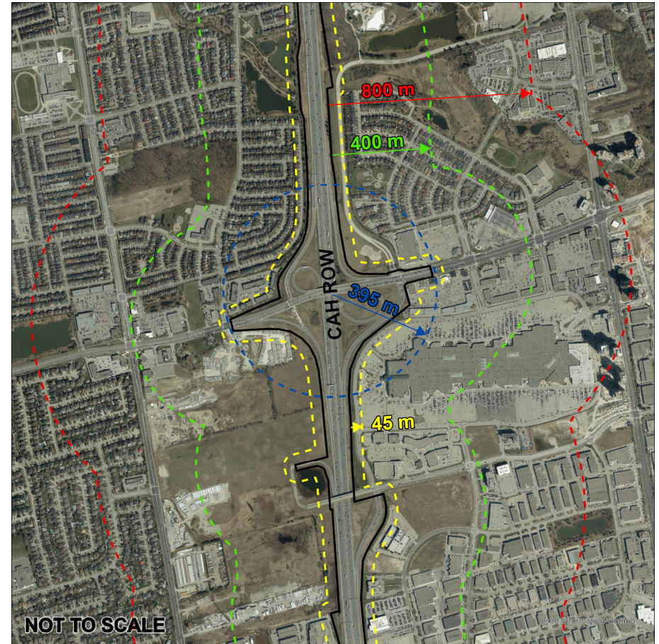
Exemple de zones nécessitant un permis du MTO : routes à accès limité
